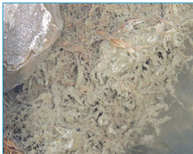
Les réactifs Water Lynx MD provoquent l'agglutination des petites particules
