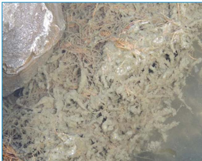
Les réactifs Water Lynx<sup>MD</sup> provoquent l'agglutination des petites particules
