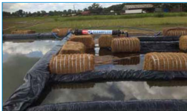
Les blocs Water Lynx MD réduisent les solides totaux de 880 mg/L à 9 mg/L
